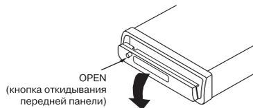
2. Для снятия передней панели приподнимите ее под небольшим углом, затем выньте правый край передней панели, а затем ее левый край.
